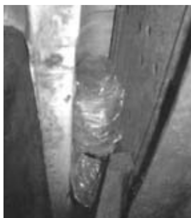
An der Fahrzeugunterseite in einem Hohlraum befestigtes Tracking-Modul. Zum Schutz vor Spritzwasser ist es mit Plastik umwickelt. Im Winter erhöht eine Verpackung auch die Lebensdauer der Batterie (Schutz vor Entladung durch Kälte)
