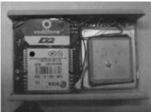
Innenansicht eines GPS-Tracking-Moduls. Links oben die GSM-Karte für die Übertragung der Daten per Mobilfunk
